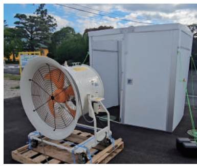
風速 15m/s の 強風試験をクリア
