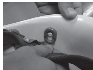
②ヘルメットを裏返した状態で内装の取付部の下部分を持ちます。
