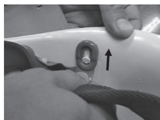
③そのまま内装を上へ引き上げる際の大きい孔から抜きます
