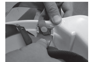
②ヘルメットを裏返した状態で内装の取付部の下部分を持ちます。
